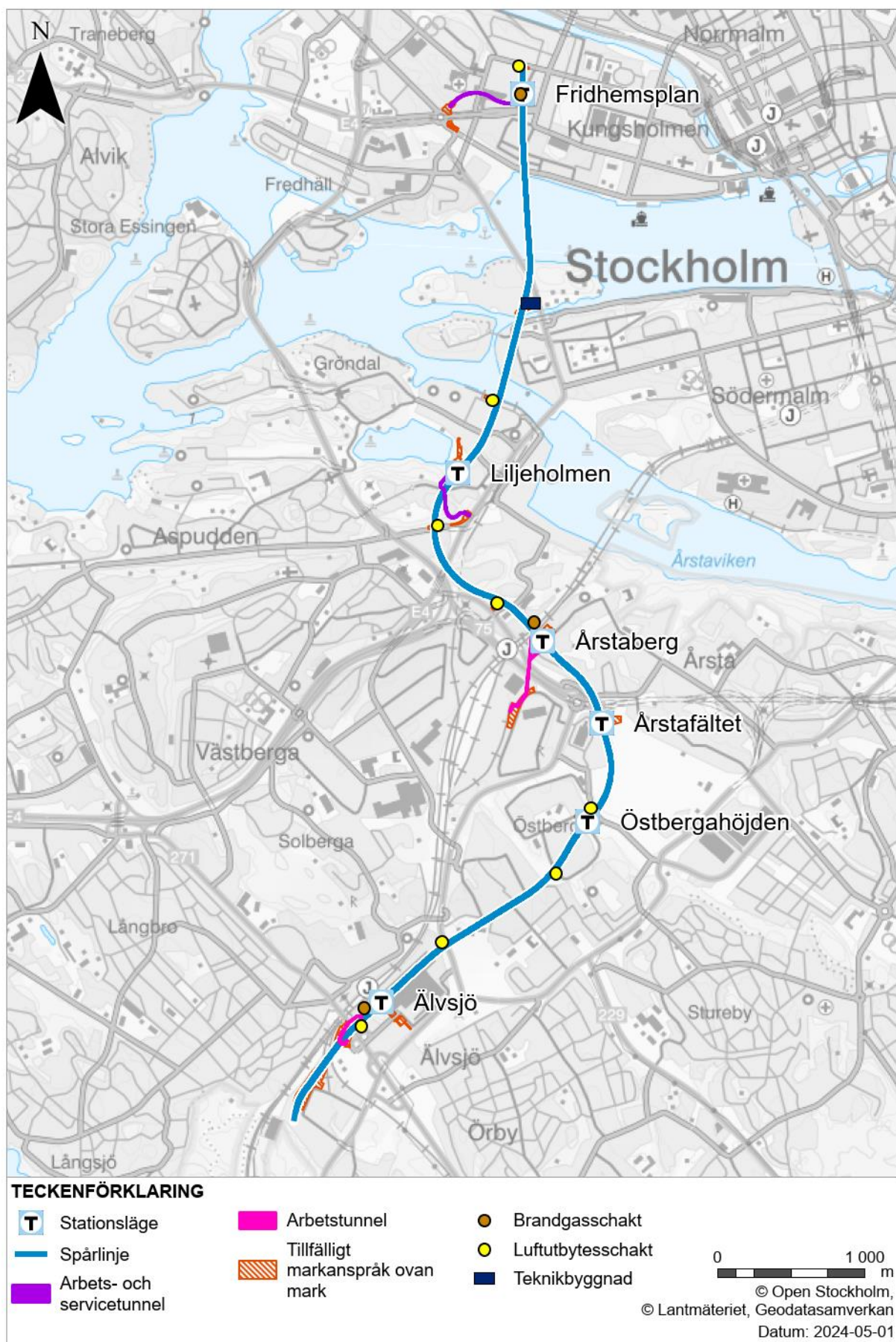
Figur 1. Planerad dragning av spårlinjen, planerad lokalisering av stationsentréer, ovanmarksanläggningar, tillfälliga markanspråk ovan mark samt servicetunnlar och arbetstunnlar.
